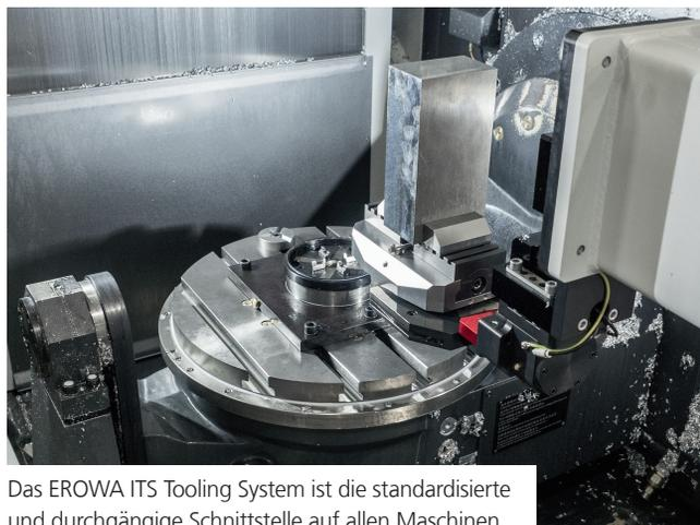
Das EROWA ITS Tooling System ist die standardisierte und durchgängige Schnittstelle auf allen Maschinen.
