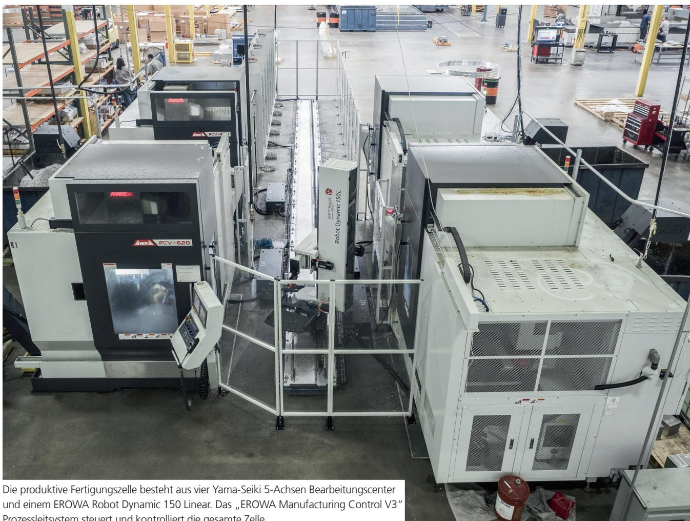
Die produktive Fertigungszelle besteht aus vier Yama-Seiki 5-Achsen Bearbeitungszentren und einem EROWA Robot Dynamic 150 Linear. Das „EROWA Manufacturing Control V3“ Prozessleitsystem steuert und kontrolliert die gesamte Zelle.
